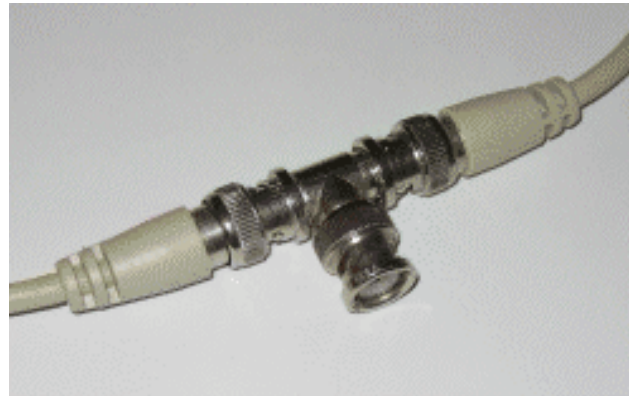
Obr 3 kabel s průchozím BNC T-konektorem
